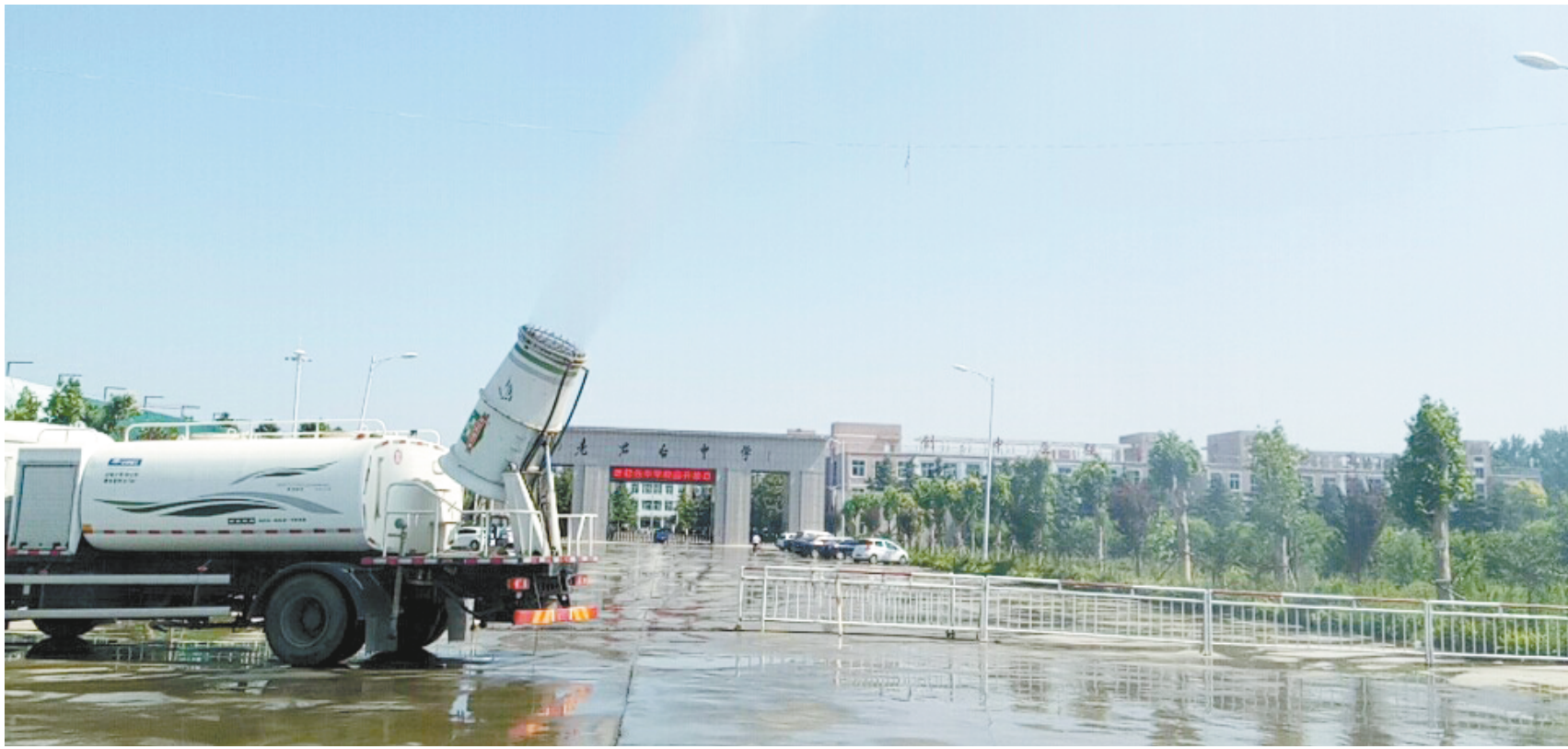
洒水抑尘车辆正在作业。
