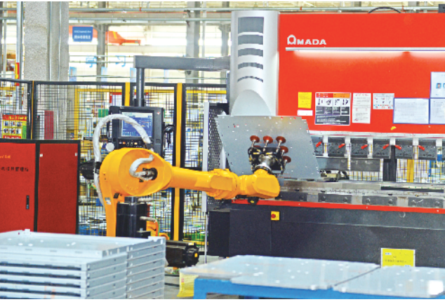
智能机器人在配合数控钣金设备加工开关柜板材。牛智广 王尧 摄
