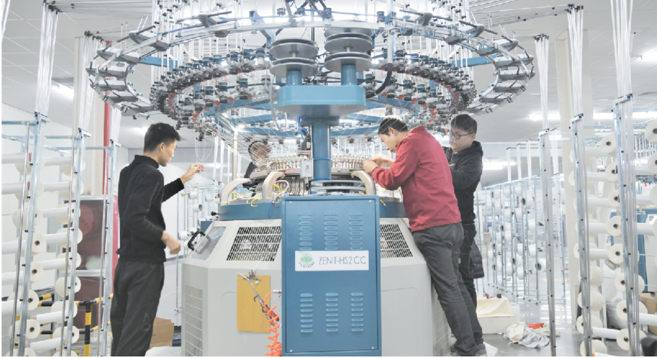
商水县盛泰浩邦纺织工业园 建设和招商工作立足高起点、高 标准，鼓励入驻的各纺织服装企 业引入先进生产设备和生产工 艺,推动整个产业链的高端化、智 能化、绿色化、安全化发展。图 为近日纺织技术人员检修针织大 圆机。
