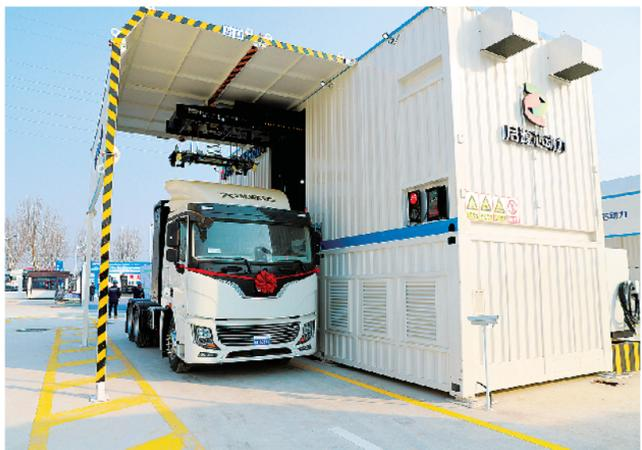
新能源重型卡车在换电站更换电池。
