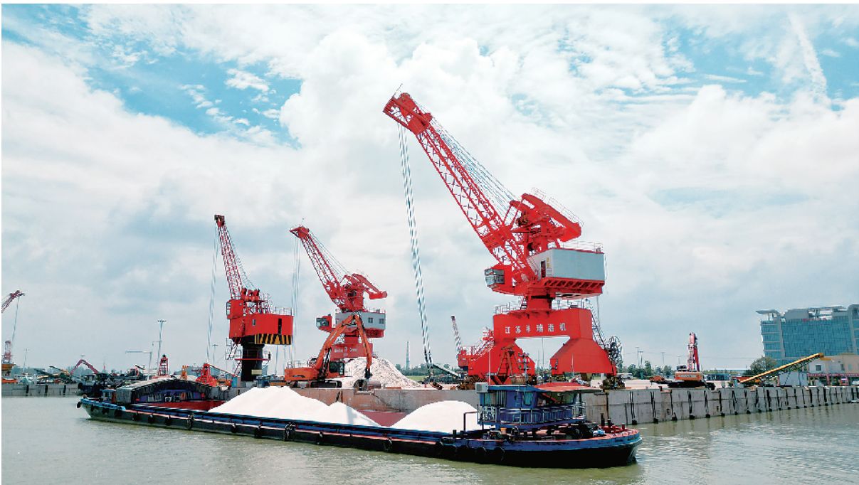
周口中心港范营作业区的多功能门座式起重机正在将白云石装船。
