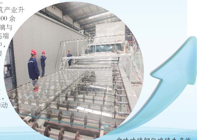
中玻玻璃钢化玻璃生产线。
