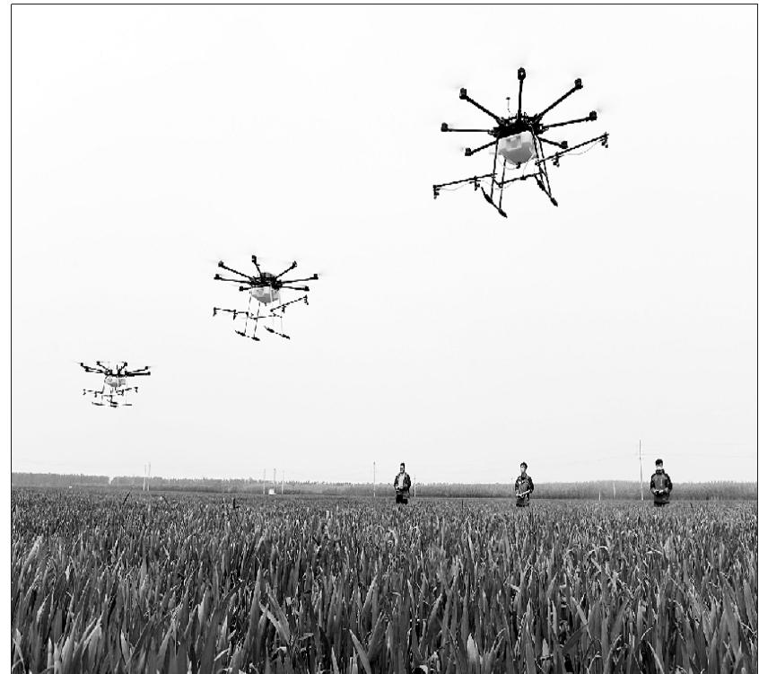
5月2日，在河北省南和县，植保人员操作无人机给小麦喷洒农药。时下正值河北、河南冬小麦抽穗、灌浆的关键时期，各地农业部门积极指导农民抢抓农时，对冬小麦进行防病虫、防干热风、防倒伏等“一喷三防”作业，确保夏粮丰收。新华社发
