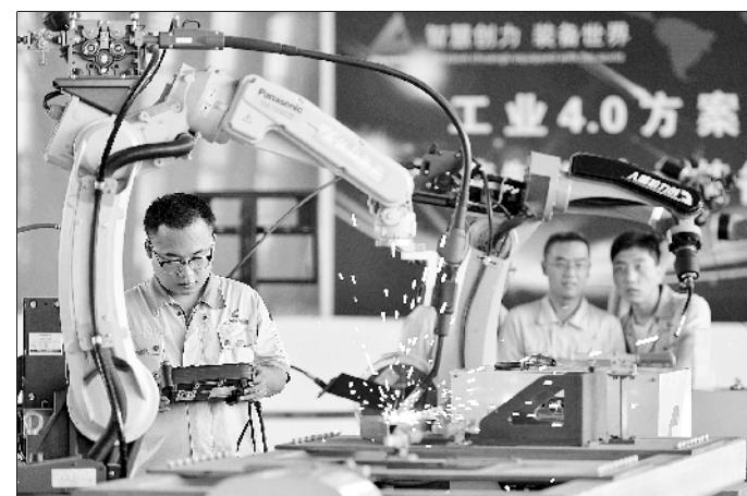
9月5日,河北创力机电科技有限公司工人对焊接机器人进行焊接实验。
