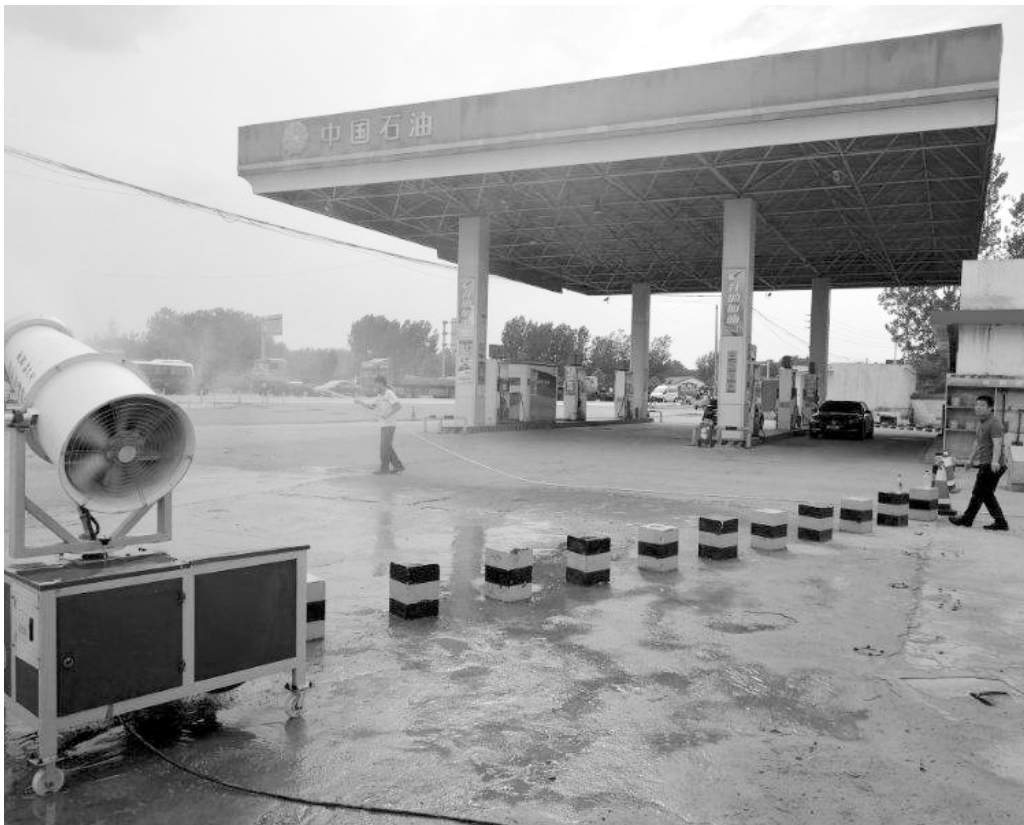
加油站已在进出道路全部安装雾炮喷淋设备
