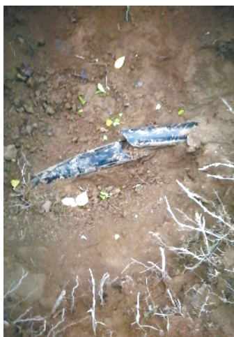
树坑里裸露的电缆线已破损
