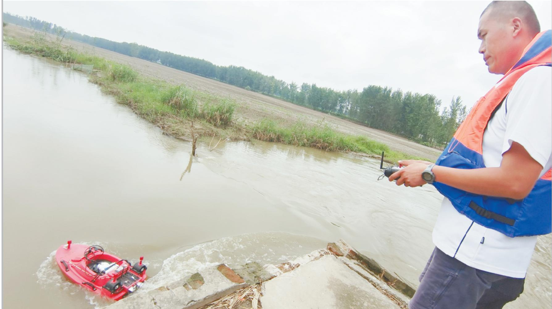
8月23下午,周口水文局工作人员在贾鲁河西华聚堆闫岗大闸遥控操作水文监测船,监测实时水位和流量,密切关注贾鲁河水情变化,确保安全度汛。②7
