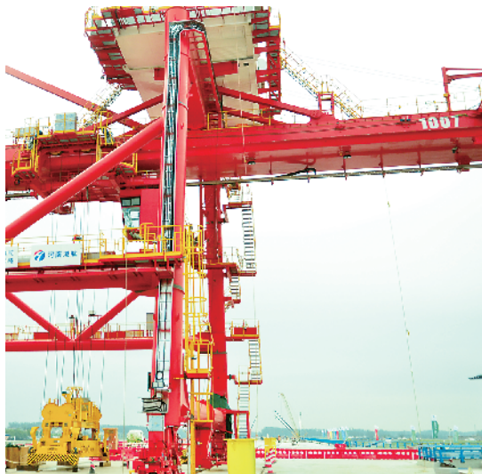
岸桥空载慢速调试现场。
