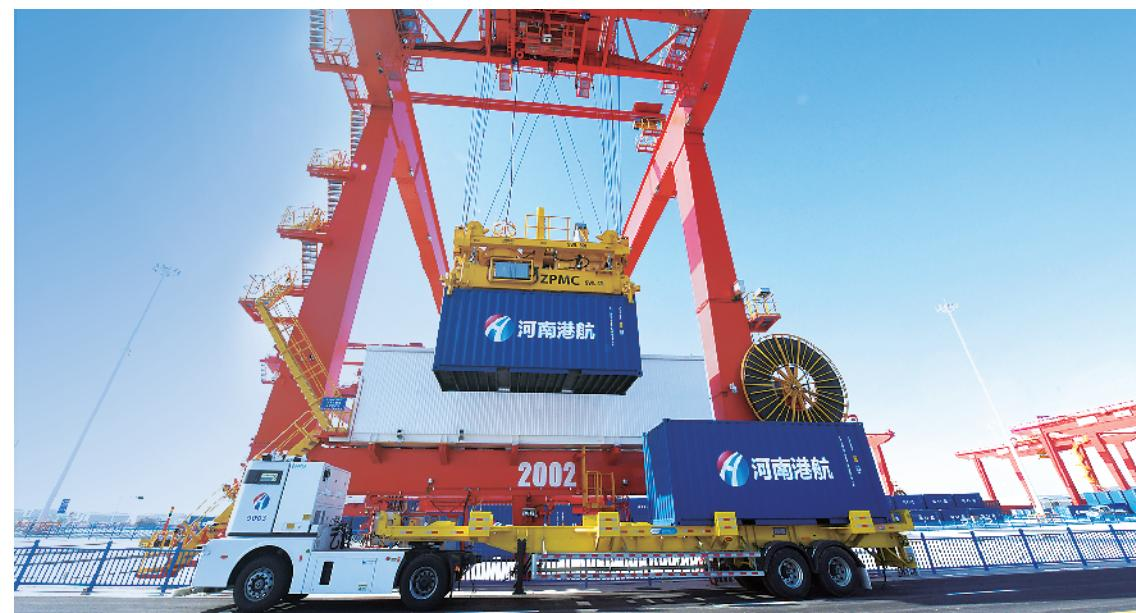
无人驾驶运输车正在进行集装箱装载调试。12月14日上午,在即将开港运行的周口中心港小集作业区一期,来自上海振华重工的技术人员正对码头岸桥等自动化设备进行最后调试。目前,开港前各项准备工作正有条不紊地推进,装卸、运输等设备均已进入调试阶段。
