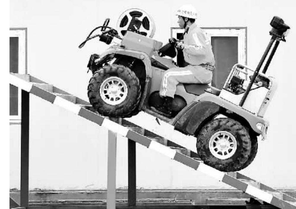
10月23日，四轮消防摩托车通过30度斜坡。当日，一种新型四轮消防摩托车亮相山东济南。这种四轮消防摩托车机动灵活、方便快捷，并配备高效细水雾灭火装置，提供泡沫和微滴两种灭火形态，为狭街窄巷、车辆密集的城市小区的消防抢险救援提供了全新保障。新华社记者 朱峰 摄
