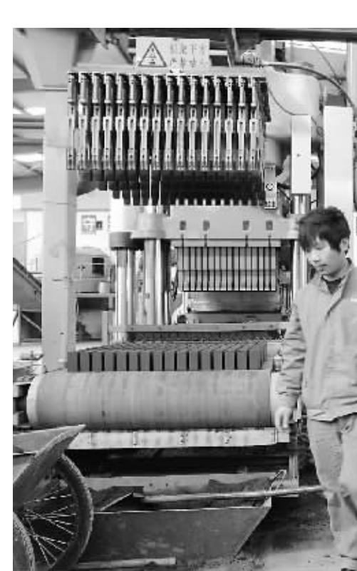
郸城财鑫集团科学发展带动产业配套建设,消化本县生产的建筑垃圾,实现了企业的综合和科学发展。图为工人正在用建筑垃圾生产建筑材料。
