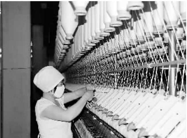
清川棉业新上3万纱锭精纺项目 该项目新上3万纱锭生产线，总投资4000万元。项目要求，6月30日前东厂房设备安装结束。项目进展情况：截至目前，细纱机4台安装校正结束，生产车间、除尘车间吊顶完毕。图为一名工人在做生产调试。
