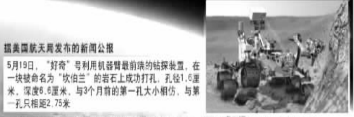
美国宇航局发布的新闻公报显示,“好奇”号利用机械臂将钻头插入一块名为“坎伯兰”的岩石上成功打钻。孔径1.6厘米,深度6.6厘米,与3个月前打的第一孔大小相当,与第一孔相距2.75米。
