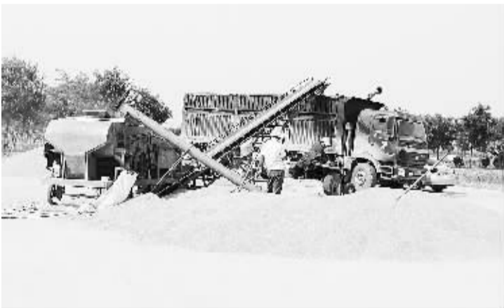
黄泛区农场夏粮全部实行收仓入库,改过去的人工扬场、麻袋包装入库为清选机清选后直接运输运粮车入库,节省了人工费用,提高了机械化程度,全场仅雇用搬运工一项就可节省费用90多万元。图为职工通过清选机、清选机、输送带直接把合格夏粮装入运粮车。(钱国顺 宁志广 摄)
