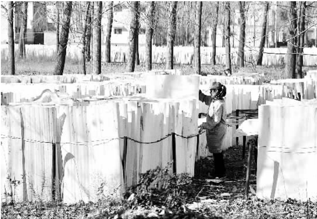
昨日，淮阳县一家杨木单板厂员工在晾晒单板。杨木单板是一种广泛用于胶合复合板加工及生产的生产原料。由于原材料丰富，该县数十家企业有着生产优质杨木旋切板面皮、修补板、杨木单板的传统，产品受到了广大客户的青睐，远销山东等周边省市。（记者 沈湛 摄）
