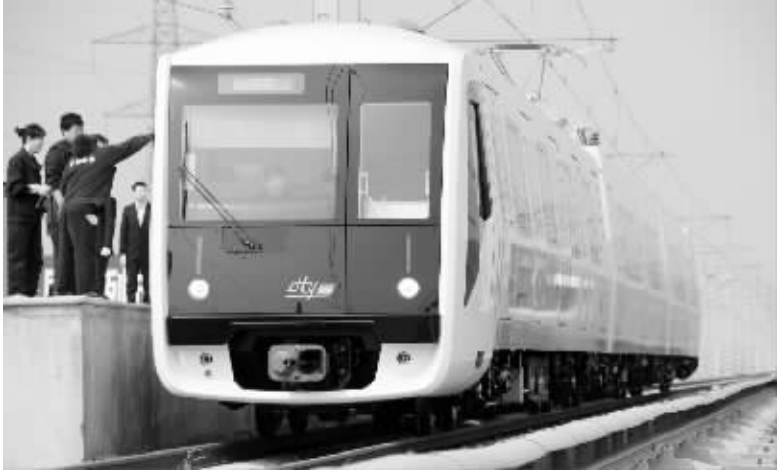
中国首列市域快轨车辆在长春下线试乘 4 月 24 日,中国首列市域快轨车辆在长春客车股份有限公司厂区内试运行。当日,中国首列市域快轨车辆在中国北车长客股份公司的试乘线路上运行,该款列车采用双供电制式的受电弓,并可自动切换。
