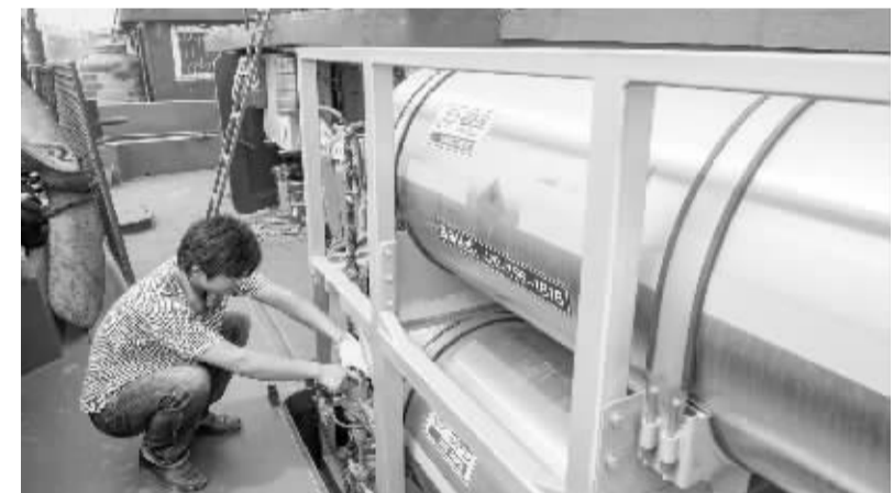
合肥市船舶“油改气”拉开序幕 5月21日,东泰168船主在合肥东港码头查看船上的天然气罐。当日,合肥市首艘“油改气”船舶东泰168船在合肥东港码头交付船东使用。船舶“油改气”项目的实施,将有效提升船舶实际运行效能,减轻对所经过的河流、湖泊生态环境的破坏。 新华社记者 杜宇 摄
