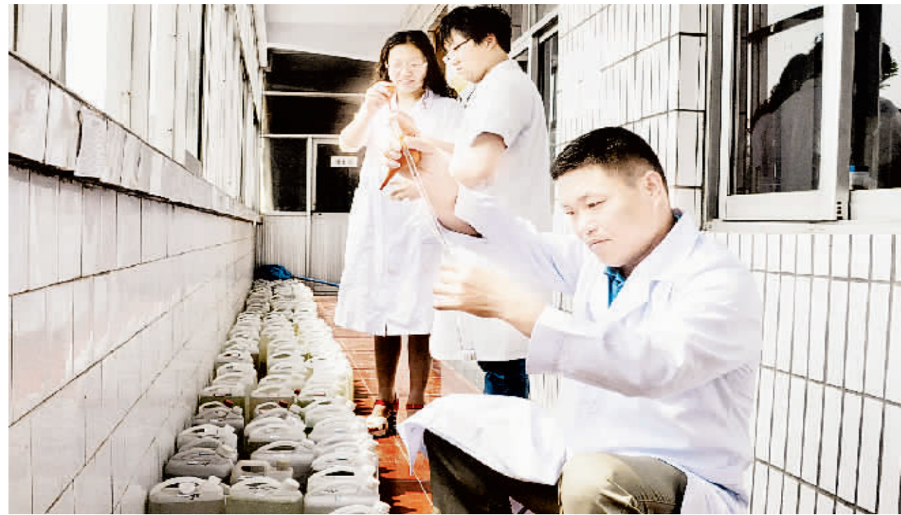
昨日,省环境监测中心周口分中心的工作人员在对市内入河排污口的水样进行化验。淮河流域入河排污口上半年监测工作目前正在进行中。通过监测,工作人员可以掌握我市水质污染状况,给环境行政主管部门决策提供依据。(记者 王映摄)
