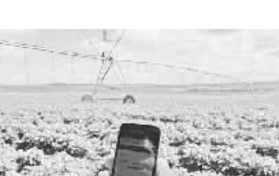
近年来，河北省沽源县引进先进技术，将智能手机灌溉系统应用于大型喷灌机上。通过智能手机远程操控灌溉系统的水泵、施肥罐、电磁阀等设备，实现水、肥、药一体化控制，使灌溉不受空间和距离的限制。图为种植户正在利用手机操作喷灌机。 索宇 摄
