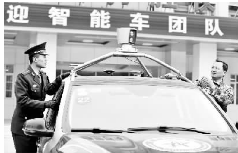
解放军军事交通学院研发无人驾驶车辆 11月20日,研发团队带头人徐友春教授(右)介绍安装在无人驾驶车辆顶部的4线激光雷达。位于天津的解放军军事交通学院无人驾驶研发团队从2004年开始研究无人驾驶车辆技术,先后完成了无人驾驶车辆在高速公路、普通道路上的系列实验,稳定性和智能性和安全性逐步提高,让研发的无人驾驶车辆行驶动作更接近人类驾驶,先后获得2012年和2014年“中国智能车未来挑战赛”冠军。无人驾驶车辆是一种智能汽车,主要依靠车内的传感器和以计算机系统为主的智能驾驶仪来实现无人驾驶,目前研发一辆无人驾驶车辆的总成本将近200万元。新华社发
