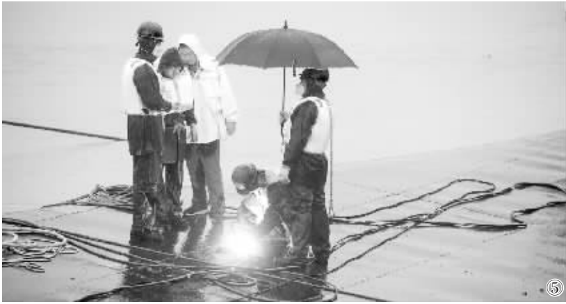
⑤ 6月4日早晨8时许, 救援人员在“东方之星”船底切割第三个探孔, 继续进行生命探测。目前, 救援人员已在翻沉的“东方之星”船底打开了两个探孔, 但均未发现生命迹象。救援人员又迅速将这两个探孔封上。在现场指挥救援的中国船级社武汉分社总经理王志刚介绍, 开孔是探测生命的最后一招。 本栏文图均据新华社电
