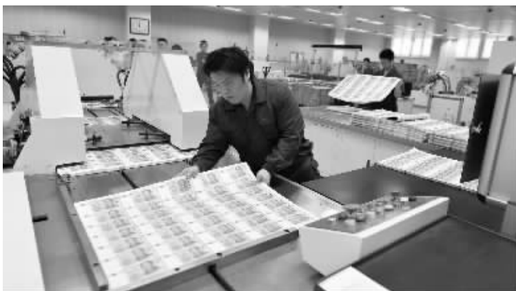
北京印钞有限公司工作人员将印制完成的大张新版百元钞票摆放在机器上进行切割(10月29日摄)。新华社发
