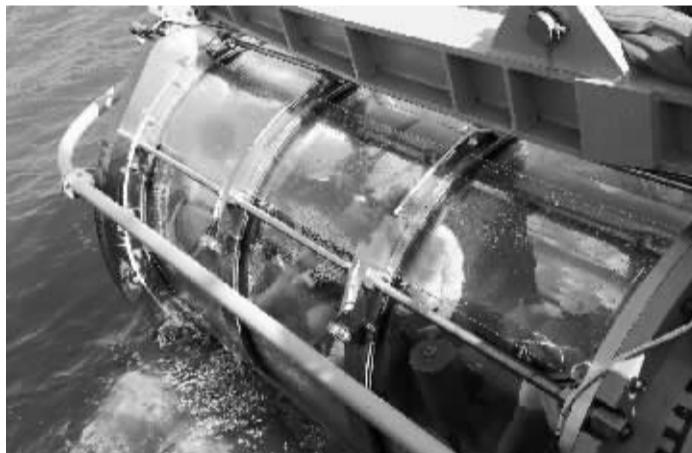
米、总宽3.6米、总高4.4米，配备供电系统、浮力调节系统、生命支持系统、空调、先进的导航控制系统。
