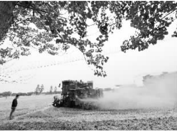
6月2日,一台安装秸秆粉碎机的联合收割机在郸城县城乡开展麦收。郸城县在全县乡村的田间地头设置三夏防火禁烧秸秆指挥部,开展县、乡、村干部分片包点禁烧秸秆。同时,今年参加机收作业的 4000 多台联合收割机全部安装了秸秆粉碎机,实现小麦收割和秸秆还田同步进行。 新华社记者 赵鹏 摄
