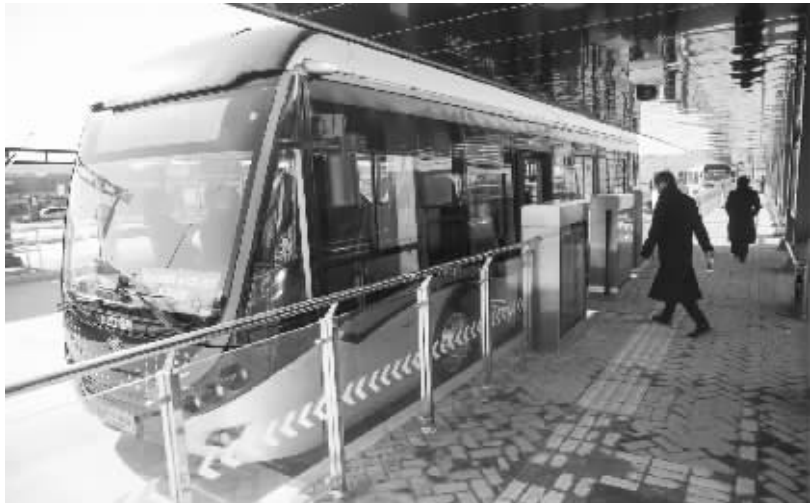
上海首条中运量公交线路进行空载联调联试 1月21日，一辆71路公交车正准备发车。当日，上海首条中运量公交线路——公交71路进行空载联调联试。该线路全长17.5公里，全线设车站25组，采用专用道路为主、局部路段混行的方案。公交车辆采用纯电动双源无轨电车，实现零排放。 新华社发
