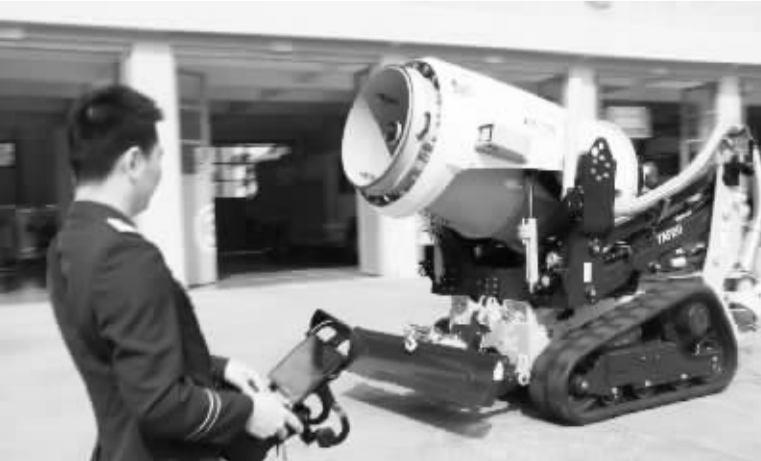
多功能消防灭火机器人亮相厦门 3月21日,福建省厦门市消防支队特勤大队队员在演示操作多功能消防灭火机器人。日前,一台多功能消防灭火机器人在厦门消防支队特勤大队正式投入使用。该款机器人可无线遥控操作,具有灭火、排烟、探测、破拆、摄像等功能,可应用于石油化工、机场、隧道等各种类型火灾处置。新华社发
