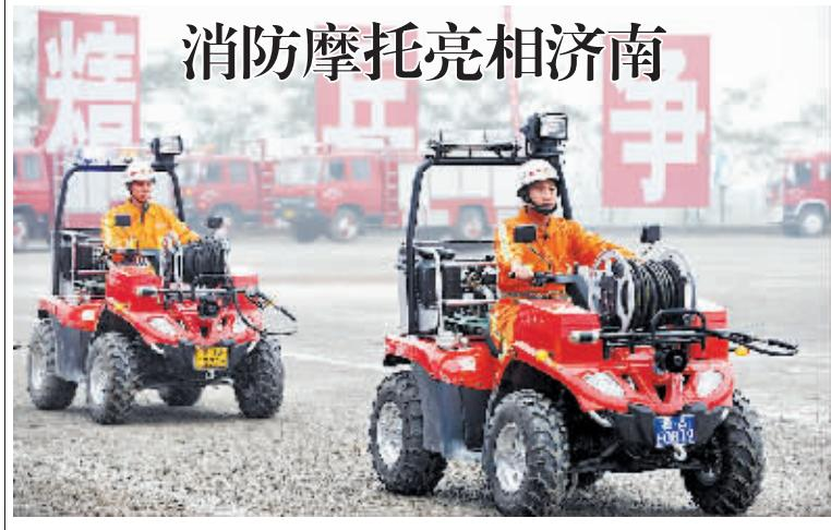
10月23日,消防人员驾驶消防摩托进行训练。当日,一种新型四轮消防摩托亮相山东济南。这种四轮摩托车机动灵活、方便快捷,并配备高效细水雾灭火装置,提供泡沫和微滴两种灭火形态,为狭街窄巷、车辆密集的城市小区的消防抢险救援提供了全新保障。
