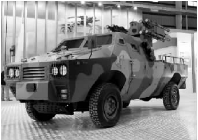
国产 TD2000B 弹炮合一近防体系中的导弹系统
