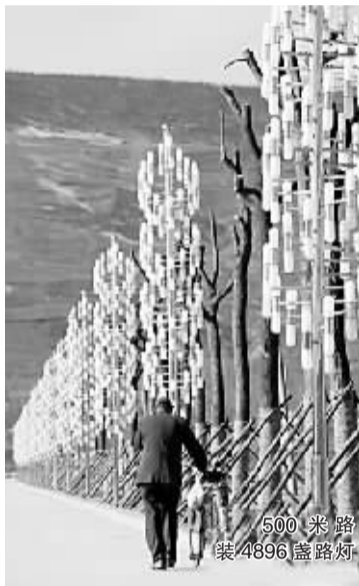
一个灯杆上安装了136个灯泡,每个灯泡11瓦,耗电量大。
