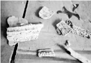
“水泥纸箱”受压断裂
