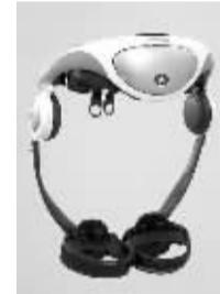
这套由日本公司设计的助力装置，可以帮助肌肉力量不足的老年人提高行走速度、延长行走距离，使爬坡更容易，同时还能监测佩戴者的心跳自动调整行走速度。这套装置重2.8千克，内置锂离子电池，有大中小不同的型号可供选择。
