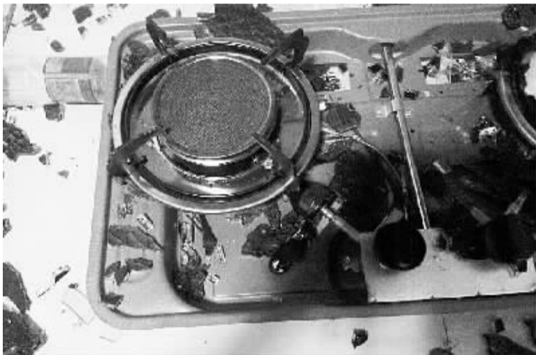
液化气灶的面板被炸得支离破碎
