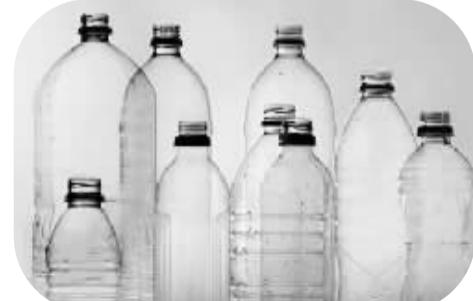
**真相:**目前市面上90%的塑料瓶装饮料采用PET材料作为瓶体材料。PET的结构相当稳定,其熔化温度超过250℃,要发生化学变化至少要在100℃以上。汽车内显然达不到这样高的温度,温度升高后就析出有毒物质的说法没
