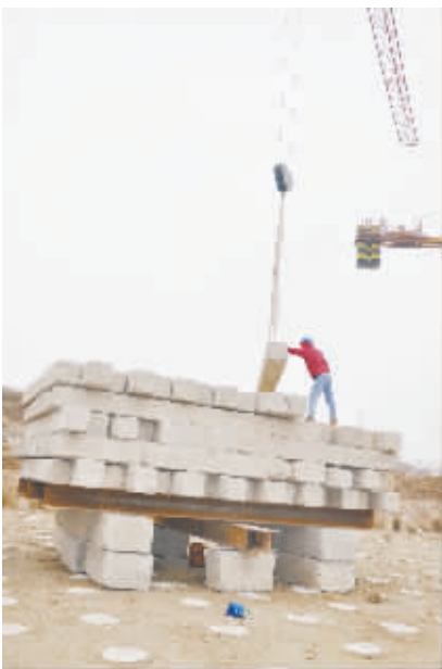
做桩基承载力静载试验
