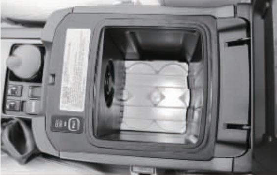
部分SUV将车载冰箱设置在了前排的中央扶手内,方便前排驾驶者和乘客取拿物品。图为普拉多的车载冰箱。
