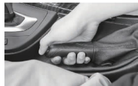
忘松手刹会导致手刹片加速磨损，手刹拉线异常拉伸，严重的会导致拉线断裂。
