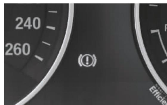
手刹指示灯亮起，表示没有松手刹或没有完全松开手刹。
