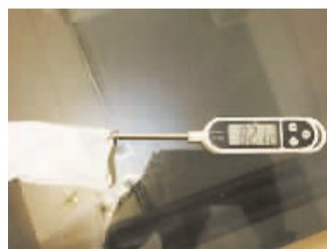
**实验过程：**将六款暖宝宝样品依次取出一片，撕开黏胶上的一层纸，包裹住数显笔式温度计的检测针，观察温度计显示屏上的温度变化。随后，将温度计放在衣物中，模拟暖宝宝正常使用时的环境，观测温度。
