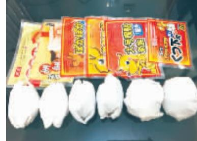
**实验结果：**1小时后，将6个鸡蛋从衣服中取出，用手接触鸡蛋时，有明显烫手的感觉。记者随后用刀从中间切开6个鸡蛋，发现由暖宝宝样品A、B包裹的两个鸡蛋已经变成半熟的“溏心鸡蛋”，其他4个鸡蛋的蛋清和蛋黄偏生。
