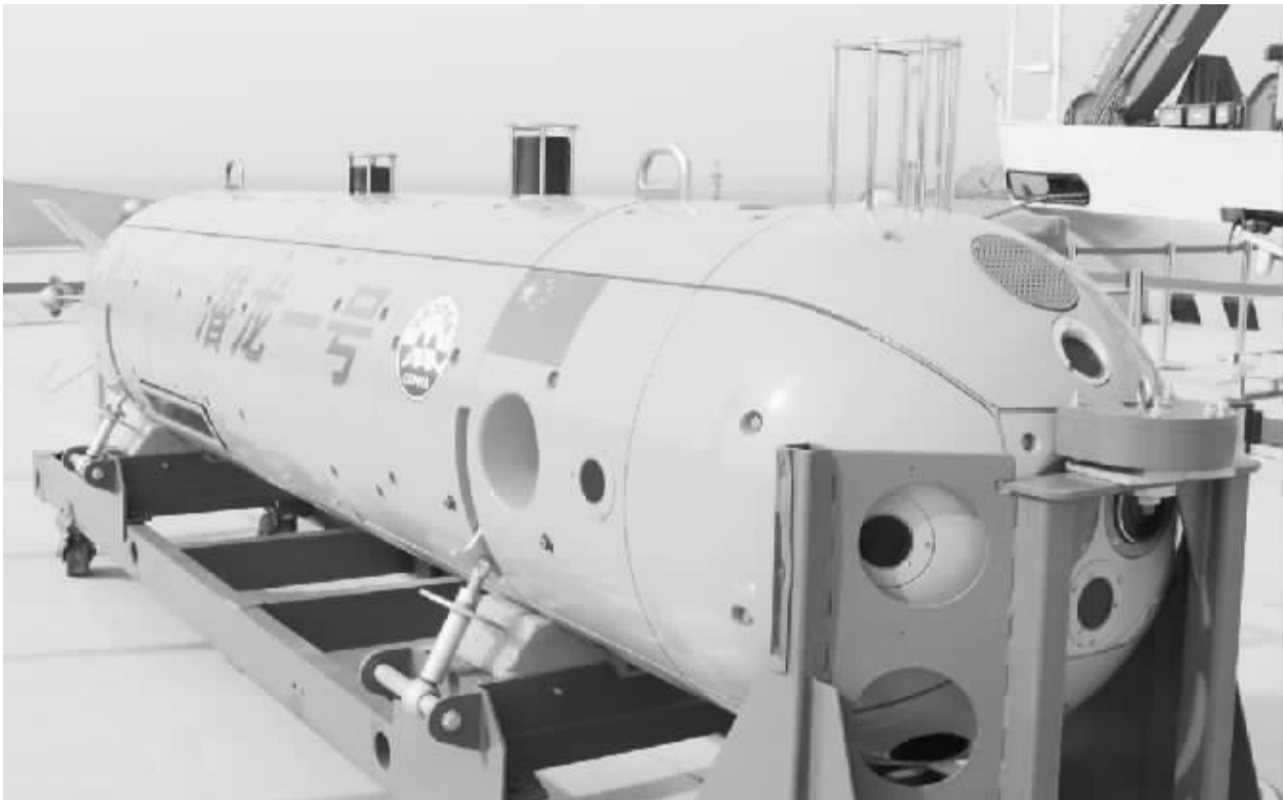
这是入驻国家深海基地管理中心的“潜龙一号”无人无缆潜水器(2月6日摄)
