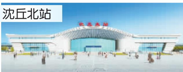
沈丘北站站房规模6000平方米,主体高度18米、长119.2米、宽39.2米。
